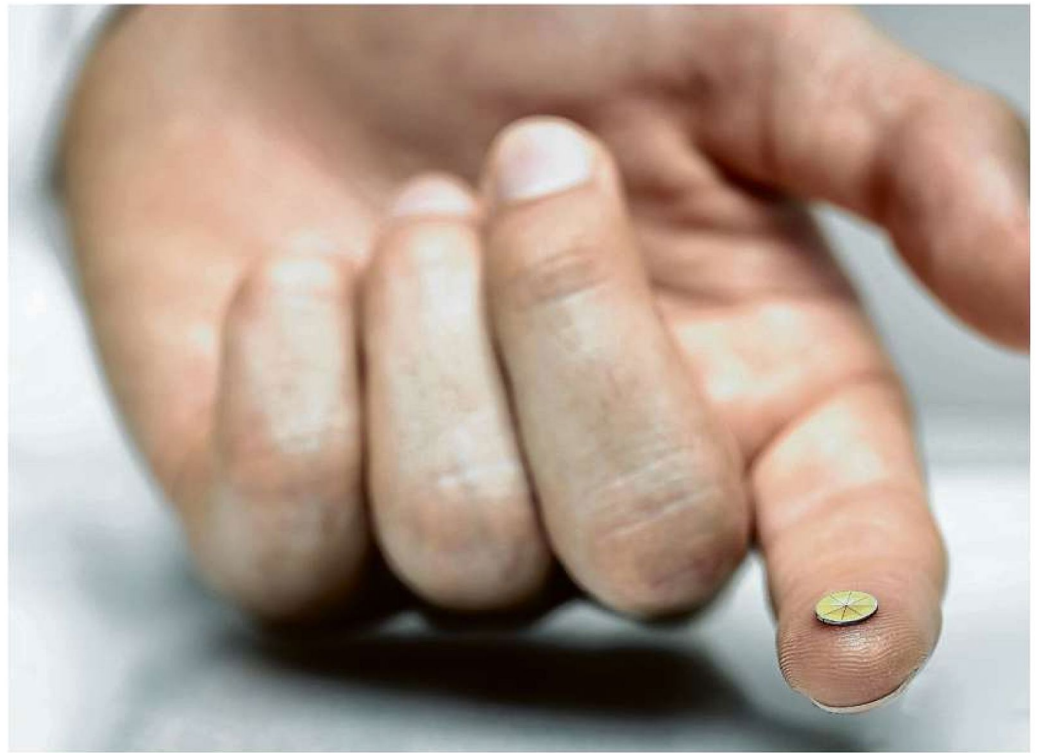
Die Hörkontaktlinse der Firma Vibrosonic hat einen Radius von wenigen Millimetern. Auf dem Trommelfell aufgesetzt, überträgt sie Schall mechanisch und sorgt so für ein laut Vibrosonic „besonders breites Klangspektrum, ohne den Gehörgang zu verschließen“. Foto: Vibrosonic
