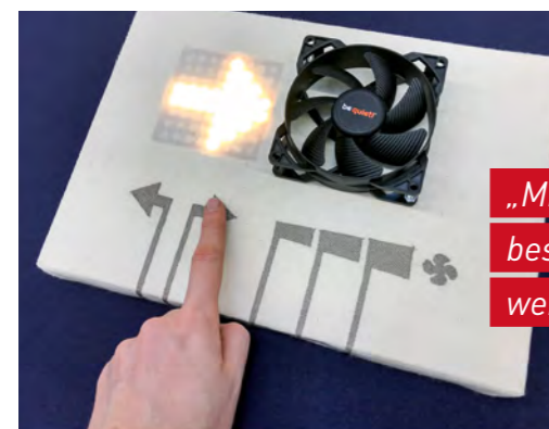
Funktionsmuster von Textilschaltern als gestickte Version
